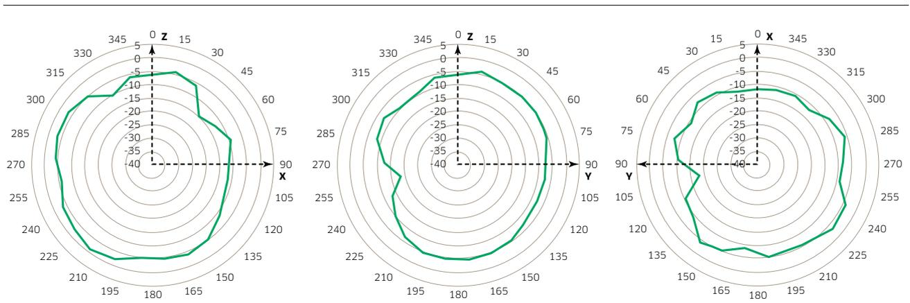
Figure 2. Tracés de modèles d'antenne OmniAccess AP1201
